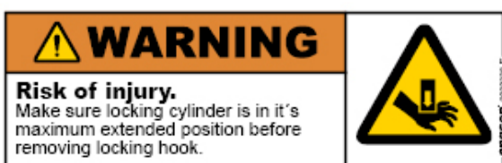
Afbeelding27. Waarschuwingsticker op vergrendelcilinder.
